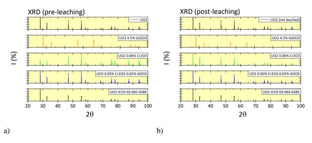
Figure 2.1.4.3.- XRD of solid sample pre-leaching (a) and after 136 days of leaching time (b) for  $UO_2$ -0.06 $^{\rm w}$ / $_{\rm o}Cr_2O_3$ ,  $UO_2$ -0.05 $^{\rm w}$ / $_{\rm o}Cr_2O_3$ -0.02 $^{\rm w}$ / $_{\rm o}Al_2O_3$  and  $UO_2$ -4.5 $^{\rm w}$ / $_{\rm o}Gd_2O_3$  compared to  $UO_2$  spectra.
